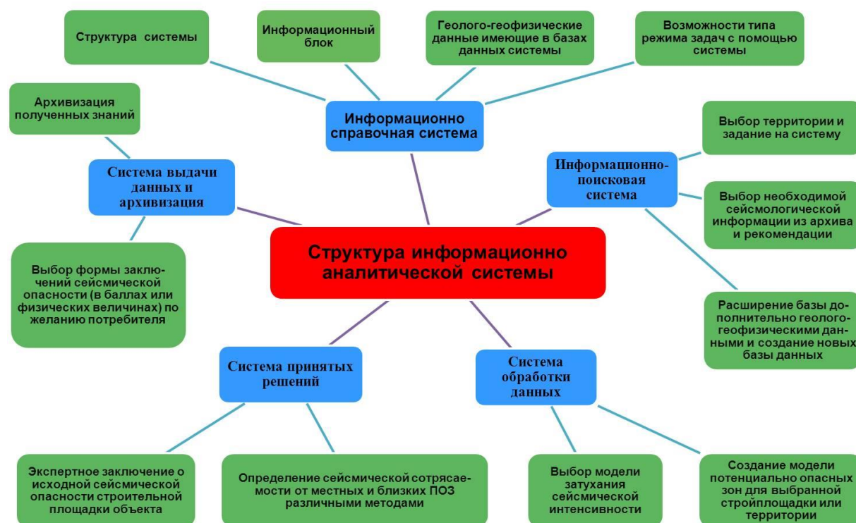
Рис.1. Структура информационно аналитической системы по оценке сейсмической опасности.
